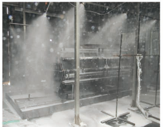
Spegnimento con acqua additivata
